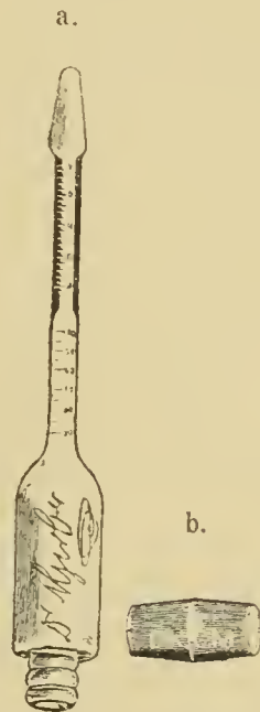
Рис. 20. а) Бутпрометрическая трубка для опредѣленія жира по способу Гербера. б) Резиновая пробка для бутпрометрической трубки.
